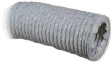
Conducto flexible aislado, fabricado con film de resinas poliolefinicas aditivadas y máster antibacteriano/antimoho, sobre un cuerpo de alambre de acero armónico en forma de espiral. Aislamiento de polietileno reticulado expandido de células cerradas y capa externa con film de resinas poliolefinicas aditivadas.
