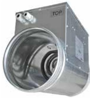
Calefactor con resistencia eléctrica de conducto montada en chapa de acero galvanizado. Puede realizar la función de protección antiescarcha o de post-calentamiento en función de la posición de montaje. Está dotado de termostato de seguridad y control electrónico de 0-10 V.
