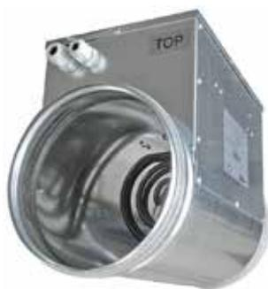
Calefactor estándar de conducto con resistencia eléctrica de 2 etapas montada en chapa de acero galvanizado. Puede realizar la función de protección antiescarcha o de post-calentamiento en función de la posición de montaje. Está dotado de termostato de regulación y de seguridad.
