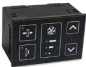
Panel de control remoto para instalación en caja 503. Se conecta a la unidad a través de entradas digitales (on-off y velocidad remota). Gestiona las siguientes funciones: encendido y apagado de la unidad, ajuste de la velocidad entre 3 caudales predefinidos, apertura y cierre del by-pass, protección antiescarcha, detección de filtros sucios y anomalías en la sonda de temperatura. Posibilidad de control (automático) de resistencia antiescarcha.
