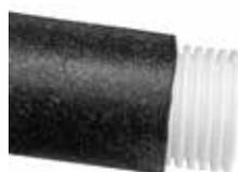
Manguera de polietileno de alta densidad de doble pared, corrugada en el exterior y lisa en el interior, específica para sistemas de distribución de aire. Gracias al uso de la tecnología Sanitized®, la tubería está higienizada durante todo su ciclo de vida. Se suministra preaislado con aislamiento de célula cerrada de 4 mm.
