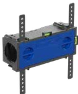
Plenum ambiente en ABS orientable para la conexión de 1 o 2 tubos de aire ambiente con sección circular DN 75 o DN 90. Posibilidad de una sola conexión desde el lateral, dos desde arriba o desde abajo. Profundidad de salida adaptable mediante soportes ajustables.
