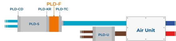
PLD-F acoplado al plenum de distribución
