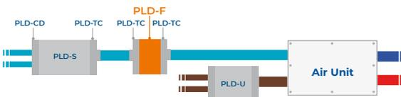
PLD-F con accesorio para conexión a 2 plenums de impulsión
