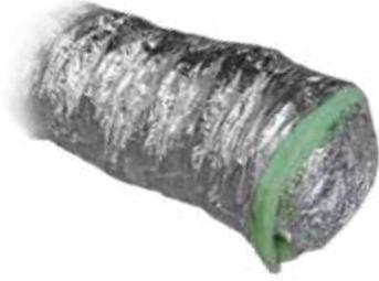
Conducto flexible aislado con aluminio microperforado para reducir al mínimo el ruido generado por el aire que fluye a través del sistema de distribución. Cuerpo de alambre de acero armónico en forma de espiral y aislamiento térmico en fibra de poliéster (25 mm de espesor y densidad de 16 kg/m<sup>3</sup>) con capa externa aluminizada (ignífuga).
