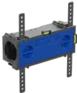
Plenum ambiente en ABS orientable para la conexión de una manguera de ambiente con sección circular DN 75 o DN 90. Posibilidad de una salida lateral única. Profundidad del hueco adaptable mediante soportes ajustables.
